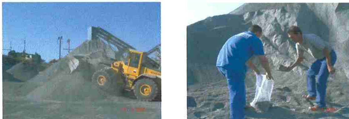
Figura 12: Coleta de amostra de basalto previamente misturado por retro escavadeira
