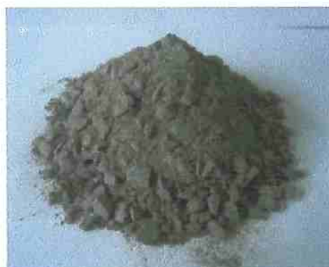
Figura 4: Fotografia de uma amostra de "pó de basalto" coletado em pedreira utilizado no estudo
