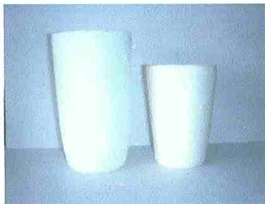
Figura 5: Fotografia dos cadinhos antes (à esquerda) e depois da queima
