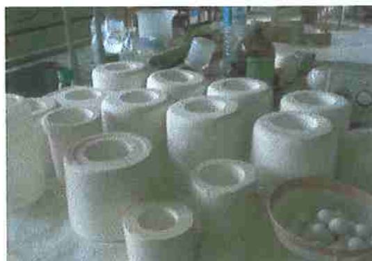
Figura 6: Moldes fabricados em gesso para a fabricação de cadinhos de alumina pelo processo de colagem
